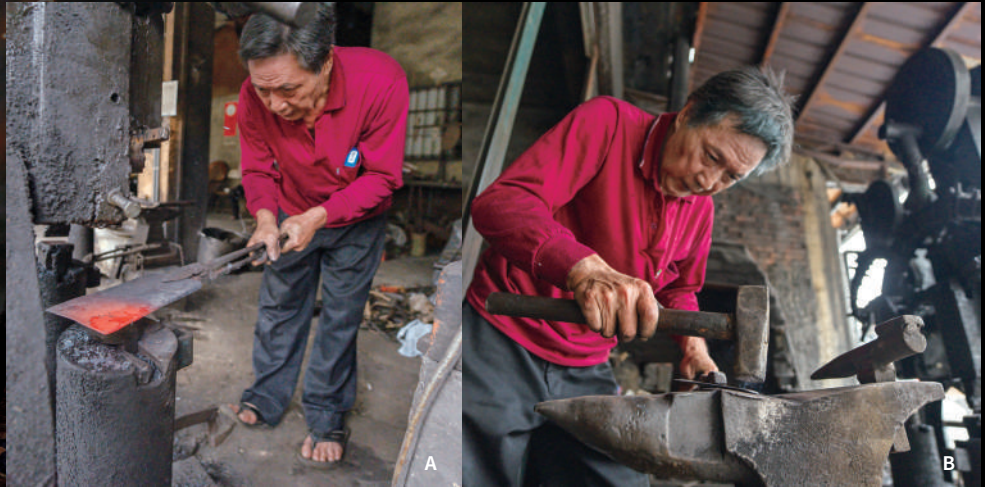
A 작업을 시작하기 전에 일단 철을 천도 넘는 섭씨로 가열 해야 한다. B 철 작업을 반복적으로 수행하면 전반적인 밀도가 높아 진다.
