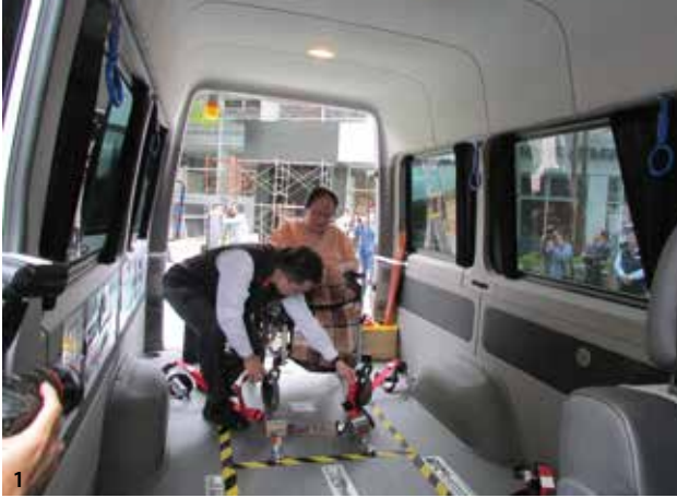
1.輪椅人士進入車內外，由服務專員協助固定 2.改裝後的LIVINA以連桿取代雙腳，可手控油門與剎車。
